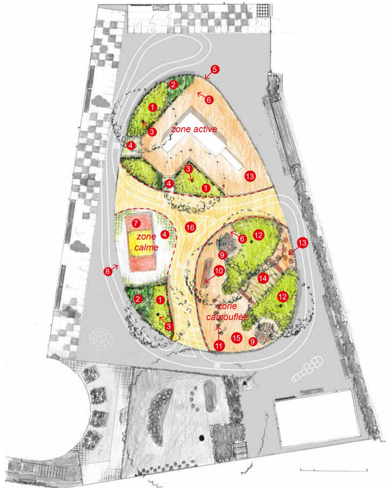
**1 2** Fourniture et plantation d'un massif arbustif et de vivaces (2) surélevé de +30 cm du Terrain Naturel existant (enrobé) avec rondins de bois verticaux d'Acacia ou de Châtaigner (diam. 12 cm min.). Les piquets sont enfoncés de -50 cm dans le sol et scellés grâce à une semelle en béton. Un lit de gravier 10/14 mm à la base des piquets assurera le drainage. Mise en place d'un système d'arrosage automatique.
