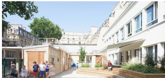
Zone de copeaux des maternelles sur dalle, surélevée pour drainer l'eau vers la zone plantée en contrebas | © Théo Ménivard/ CAUE de Paris
